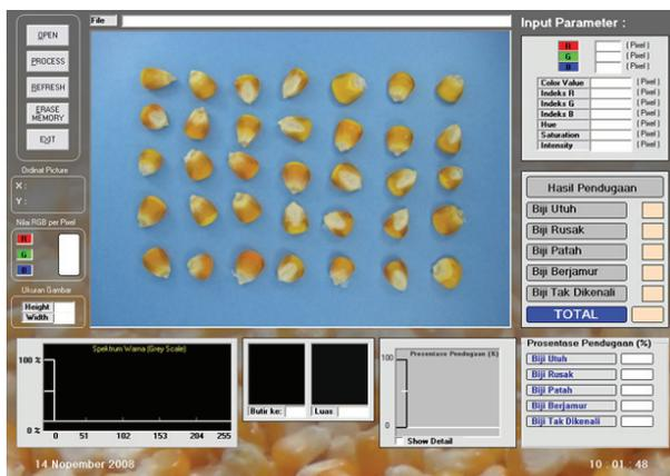
Gambar 2. Tampilan program untuk menguji mutu fisik jagung
