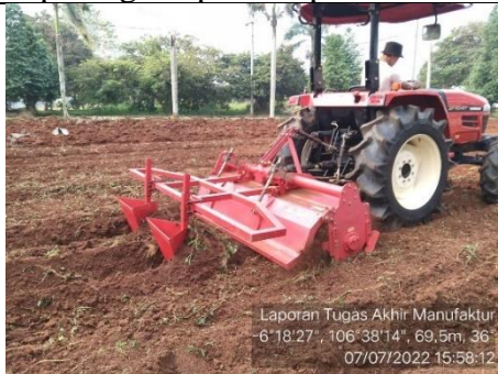
Proses pembuatan guludan menggunakan implemen penggulud
