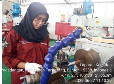
Membuat pen pengunci menggunakan mesin bubut
