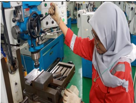
Melubangi plat besi menggunakan mesin milling
