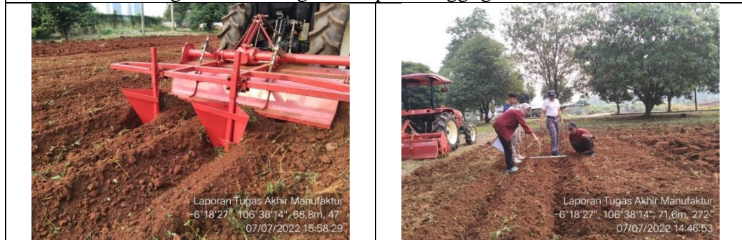
Pengukuran hasil guludan pada tinggi guludan 20 cm
