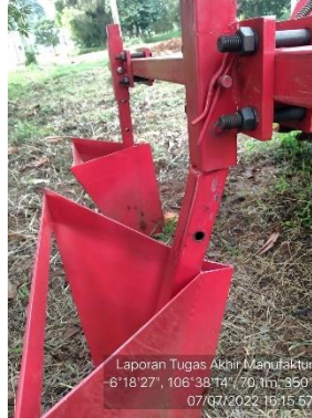
Gambar 4.16. Kerusakan komponen penopang pisau
