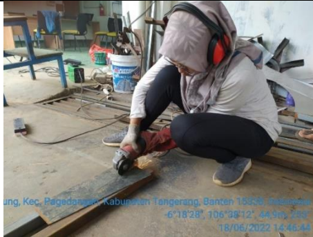
Memotong plat besi untuk dijadikan pisau guludan
