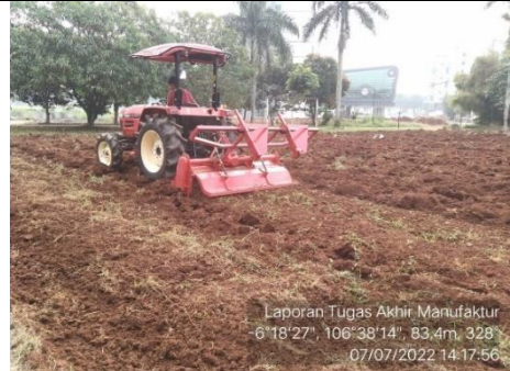
Proses pencacahan tanah menggunakan implemen rotari
