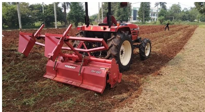
Gambar 4.15. Implemen penggulud yang terpasang pada implemen rotari
