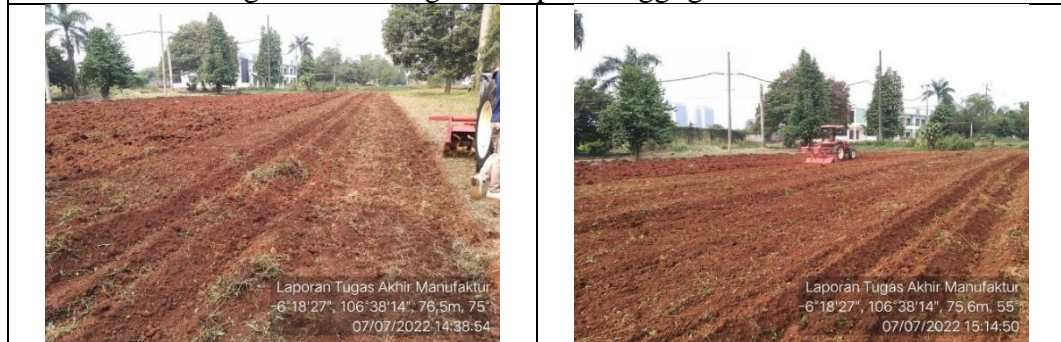
Guludan yang dihasilkan dari rancangan implemen penggulud pada traktor roda empat
