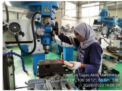
Melubangi plat besi menggunakan mesin milling
