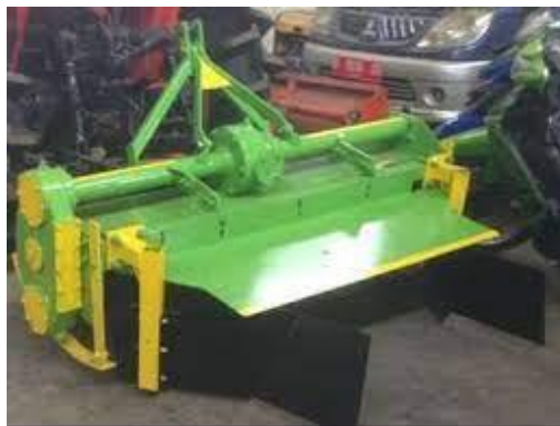
Gambar 4.1. Implemen guludan traktor roda 4 sebelumnya (Sumber: http://repository.pertanian.go.id/ )
