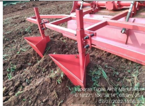
Proses pembuatan guludan menggunakan implemen penggulud
