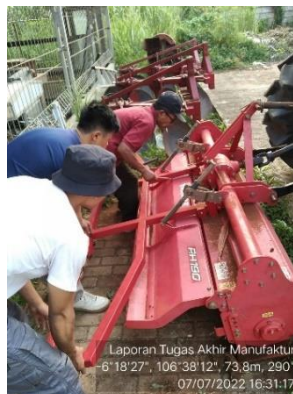
Gambar 4.13. Perakitan implemen penggulud ke implemen rotari
