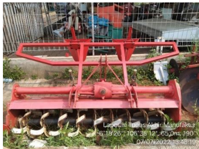
Implemen penggulud yang telah dipasang pada implemen rotari
