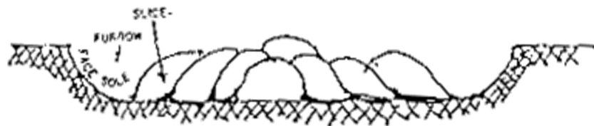
Gbr 25. Hasil Pembajakan dengan Menggunakan Bajak Piring ( disc plow )
