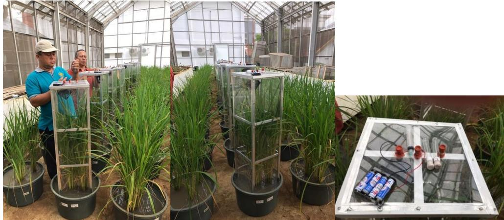
Gambar 23. Pengambilan gas metana menggunakan sungkup. [a] dan [b] sungkup polikarbonat, [c] alat pendukung yang diperlukan untuk mengambil gas metana
