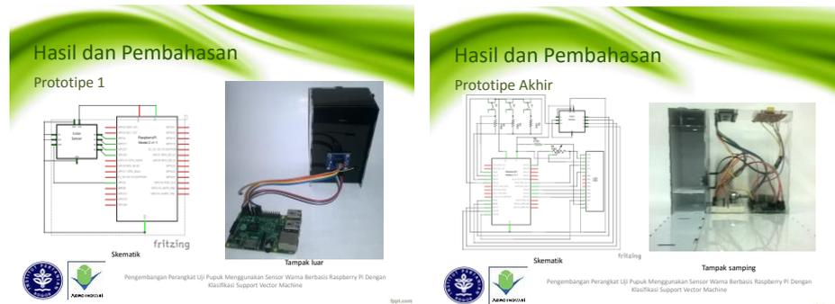
Gambar 64. Prototipe 1 Perangkat Uji Digital (kiri) dan prototipe akhir (kanan)
