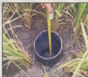
Gambar 17. Cara mengukur ketinggian permukaan air tanah dengan menggunakan meteran.
