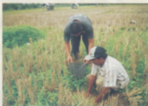
Gambar 9. Pengambilan contoh tanah pada lahan sawah yang selesai dipanen dengan menggunakan bor tanah (kiri atas). Pengambilan contoh tanah sawah yang tidak tepat, karena dilakukan pada saat padi sudah berbuah (kanan atas). Pengambilan contoh tanah dengan menggunakan cangkul (bawah)
