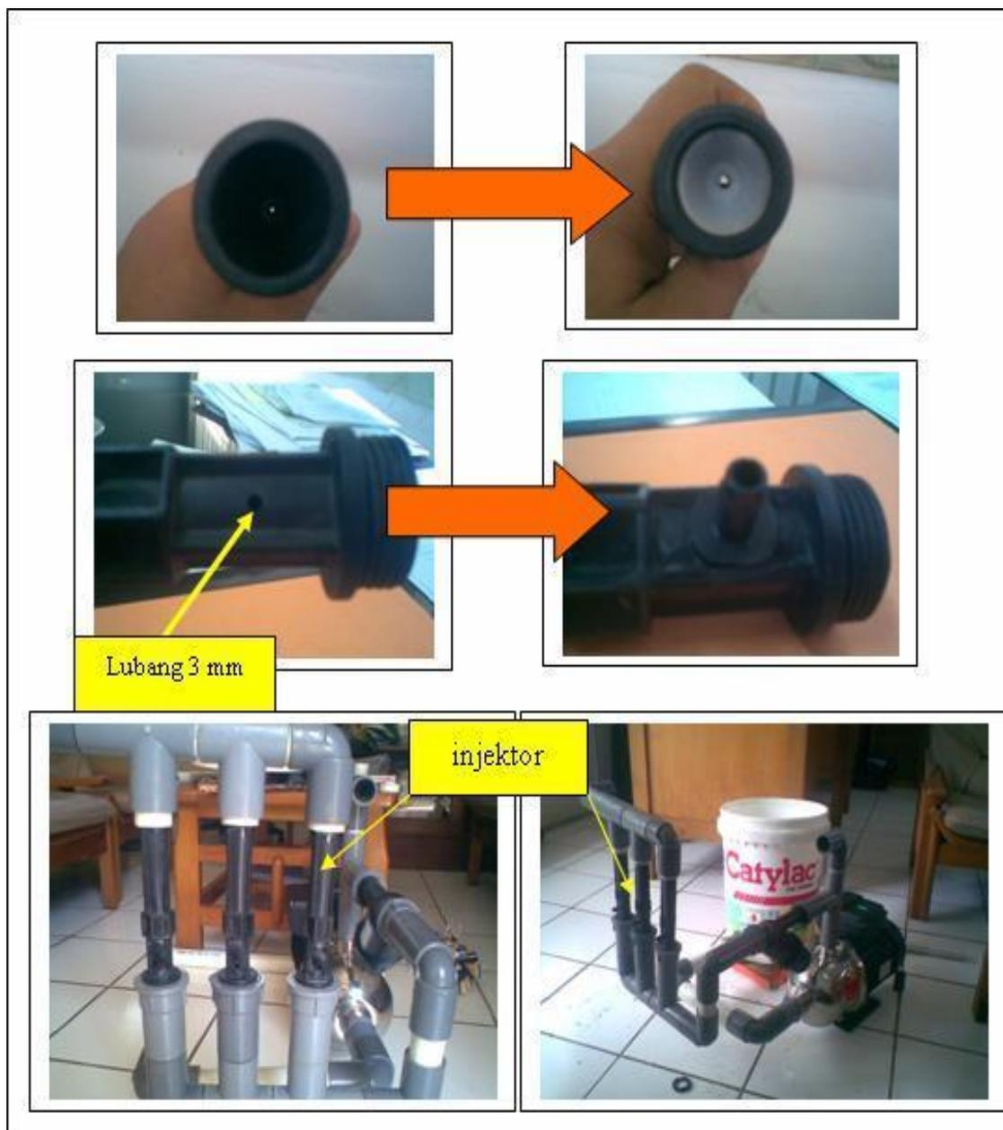
Gambar 3. Penggunaan komponen lokal pipa venturi pada prototipe mesin fertigasi
