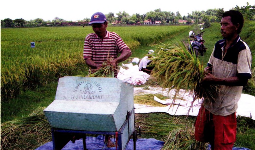
Perontokan gabah dengan alat perontok (thresher) mempercepat proses perontokan dan mengurangi kehilangan hasil yang disebabkan oleh masih adanya gabah yang tidak terontok jika perontokan dilakukan secara gebot.
