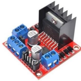
Gambar 2. 14. Module H Bridge
