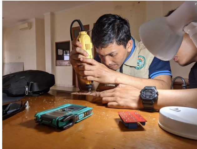
Gambar 4.19. Proses Pengeboran PCB.
