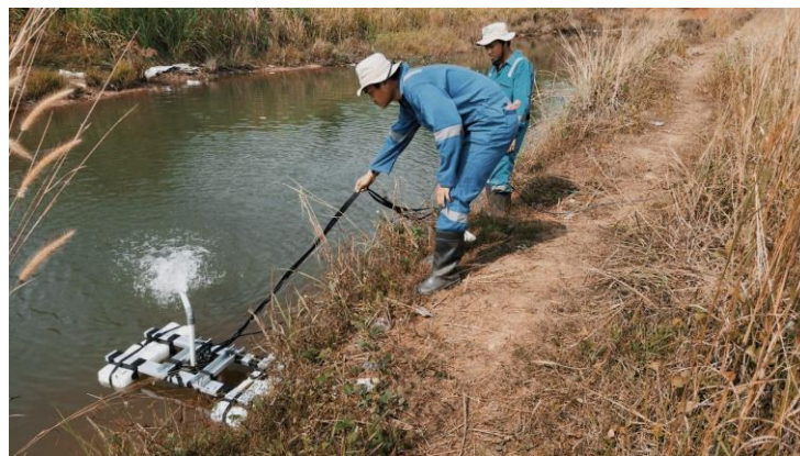
Gambar 4. 25. Percobaan Pompa Apung
