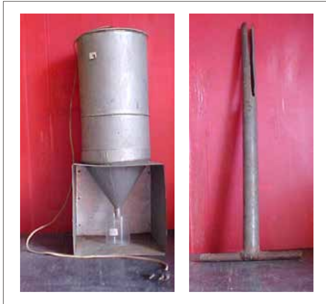
Gambar 3. Barlese Tullgren (kiri), bor tanah (kanan)
