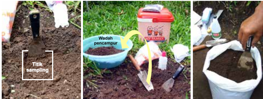
Gambar 3. Titik pengambilan (titik sampling) contoh individu (kiri), baskom (tengah) atau kantong/karung plastik (kanan) sebagai wadah pencampur contoh individu dari berbagai titik sampling untuk mendapatkan satu contoh komposit tanah non-rhizosfer
