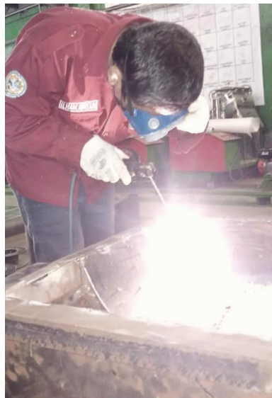
Gambar 13 : Pengecekan proses pereakitan rangka (Sumber : Dokumentasi pribadi di PT BEJE)
