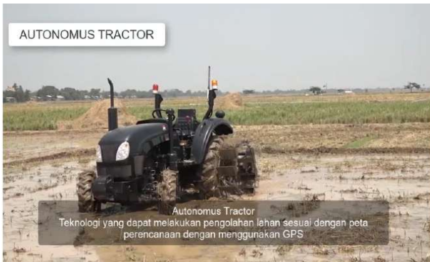
Gambar 4.8. Autonomus Tractor , Pengolahan Lahan Menggunakan GPS
