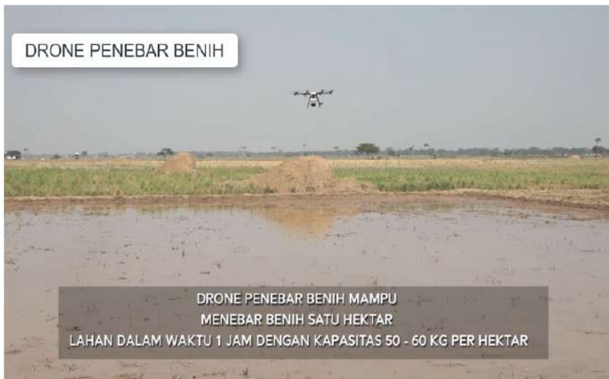
Gambar 4.9. Drone Penebar Benih dengan Kapasitas 50-60 kg/ha
