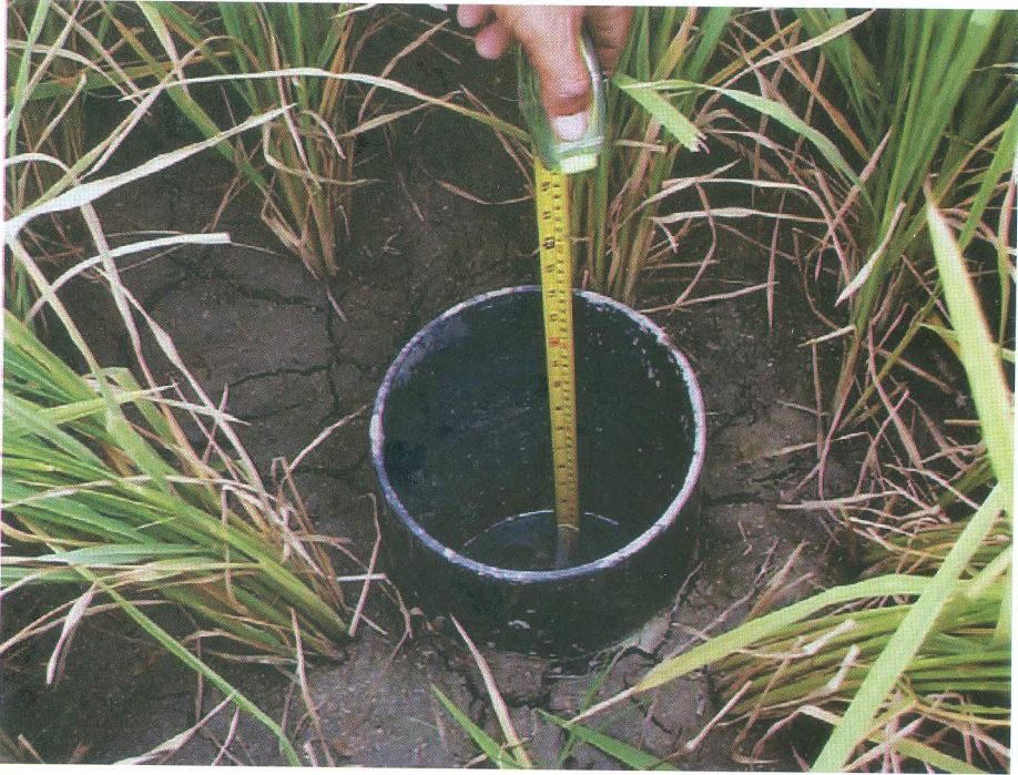
Paralon berlubang merupakan alat sederhana untuk mengukur ketersediaan air di permukaan lahan dalam upaya penerapan sistem pengairan berselang pada tanaman padi di lahan sawah.
