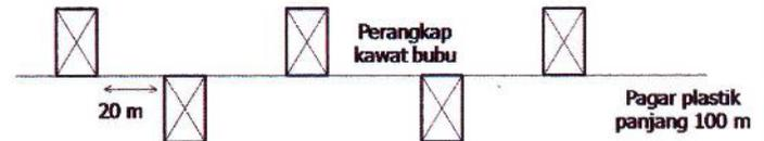
Gambar 9. Skema pemasangan LTBS (tampak atas)
