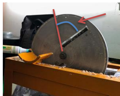
Gambar 2. Mata pisau alat perajang singkong Sumber data: pengamatan lapangan
