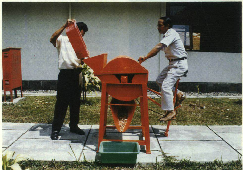
Alat pengupas buah jarak tipe Asembagus yang dikembangkan Balai Penelitian Tembakau dan Tanaman Serat
