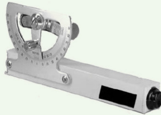
Gambar 6.9 Abney level untuk mengukur kemiringan lahan (Foto: Erfandi, 2003)
