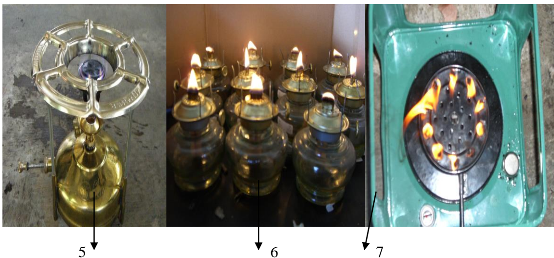
Keterangan: (5), (6), dan (7) Keragaan kompor tekan, lampu teplok, dan kompor sumbu berbahan bakar metil-ester/bio-diesel kasar.
