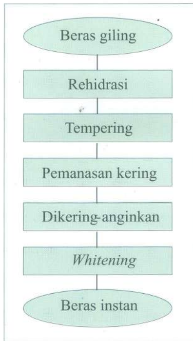
Gambar 8. Diagram alir proses pembuatan beras instan.
