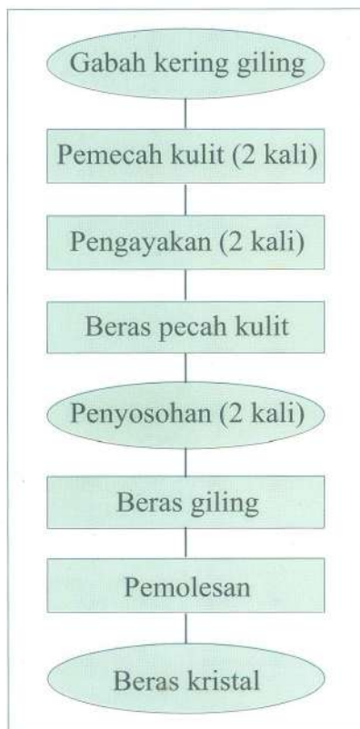
Gambar 9. Diagram alir proses pembuatan beras kristal.
