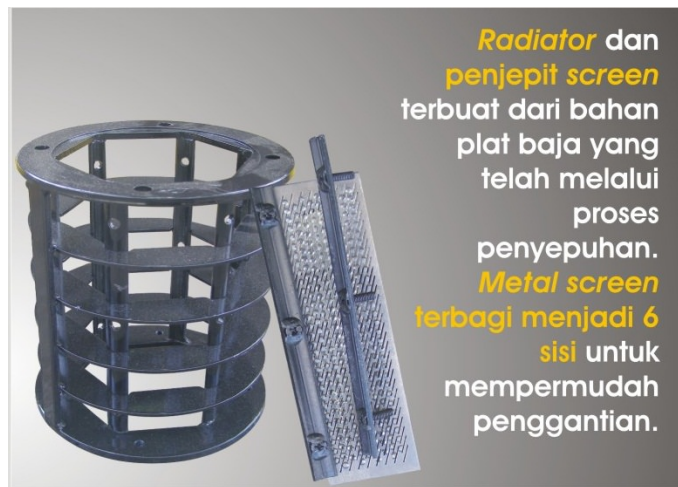
Gambar 8. Radiator dan Penjepit Screen
