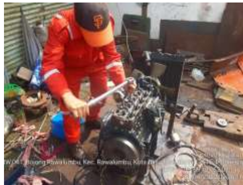
Gambar 4.3 Kegiatan pengencangan baut head cylinder dengan kunci momen tekanan 9 kg
