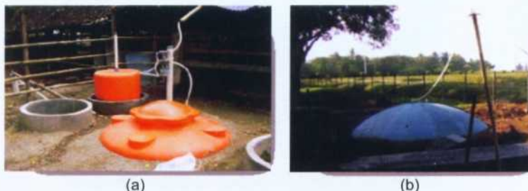
Gambar 30. Instalasi biogas yang sudah dipasarkan (a). plastik, (b). Fiber
