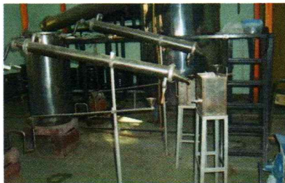
Gambar 6. Alat penyulingan kapasitas 3 kg
