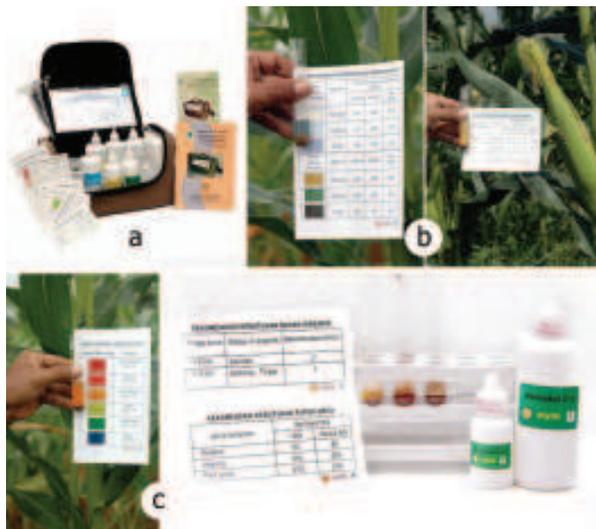
*Perangkat Uji Tanah Kering (a) serta hasil pengukuran P dan K (b), pH dan kadar karbon tanah (c).*
