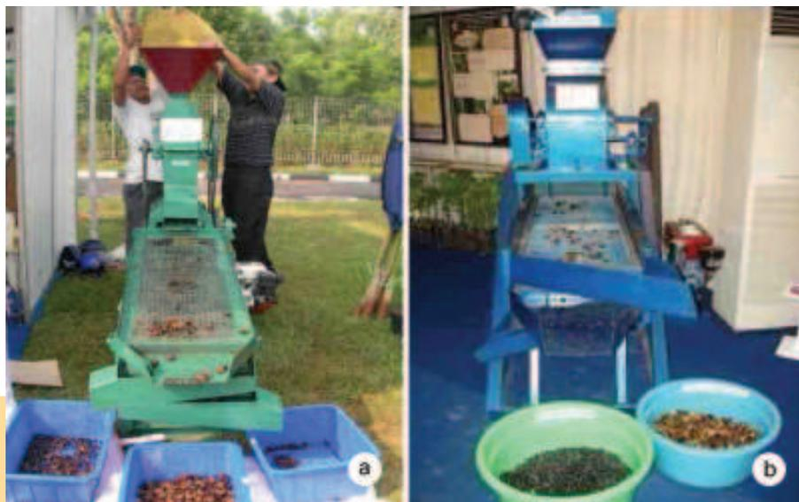
Alat pengupas buah jarak pagar tipe Balittas 01 (a) dan Balilittas 02 (b).
