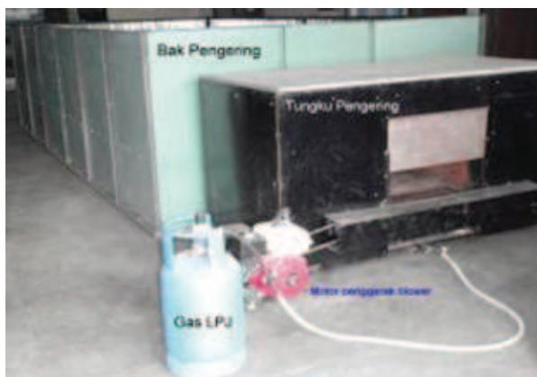
Alat pengering kedelai dengan sumber energi gas LPG.
