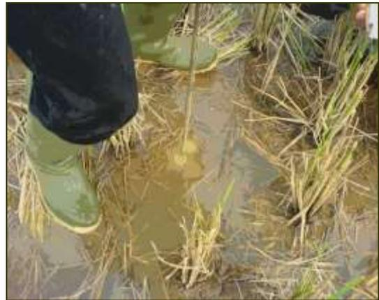
Gambar 3. Cara pengukuran daya sangga tanah dengan menggunakan *Plate sinkage* pada saat kering dan basah
