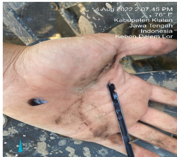
Gambar 4. 11. Mengecek warna kelayakan status oli
