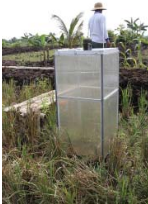
Gambar 4. Sungkup ditempatkan pada posisi yang rata agar tidak terjadi kebocoran pada bagian penampang dan menyungkupi 4 rumpun tanaman padi.
