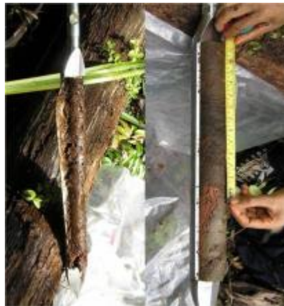
Gambar 3. Contoh tanah gambut tidak terganggu yang diambil dengan menggunakan bor gambut model Eijkelkamp dengan tabung contoh berukuran 500 \text{ cm}^3 (Foto : Maswar)
