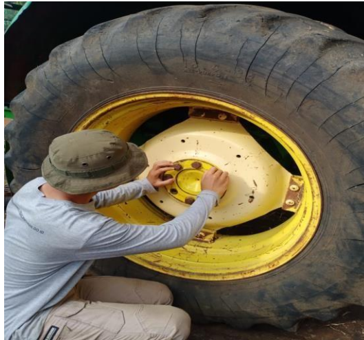
Gambar 4.6 Pengecekan Baut Roda Traktor Roda 4
