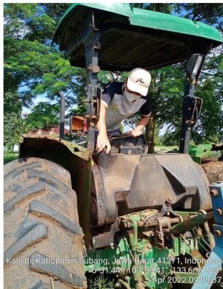
Gambar 4.5 Pengecekan Bahan Bakar Traktor Roda 4
