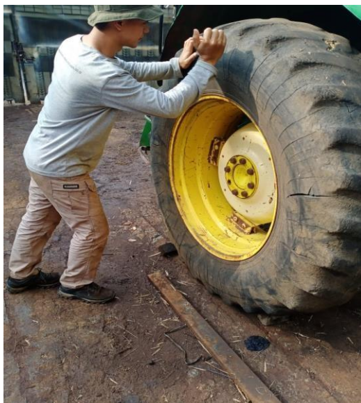
Gambar 4.7 Pengecekan Tekanan Ban Traktor Roda 4
