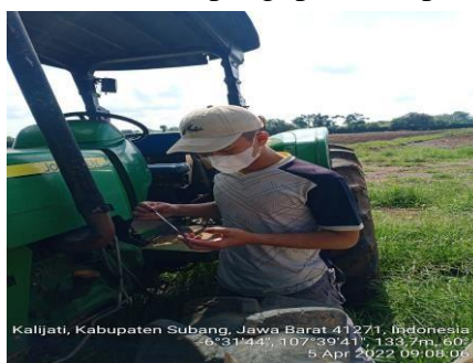
Gambar 4.4 Pengecekan Oli Traktor Roda 4
