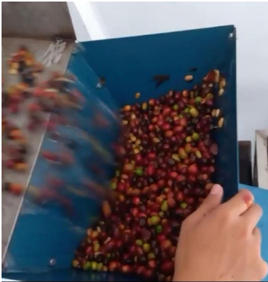
Proses pengelupasan biji kopi dari daging kulitnya
