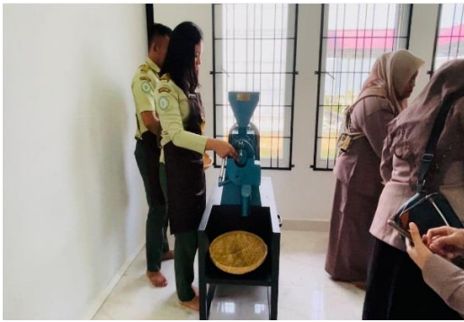
Proses Pemisahan biji kopi dari kulit ari (Huller)
