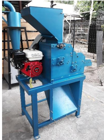
Gambar 2. Mesin Pengupas Kopi (Pulper)
