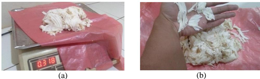
Gambar 13 : (a) Bahan rusak pada jarak 3mm, (b) Bentuk fisik bahan rusak pada jarak 3mm
