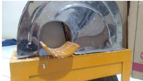
Gambar5 : Corong input pengumpan mesin perajang sawut singkong.
