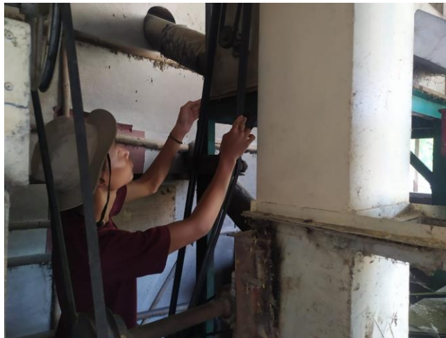
Gambar 16. Pengecekan sabuk puli
