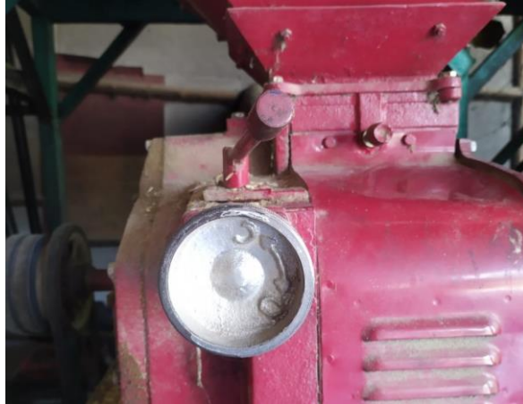
Gambar 14. Pengatur jarak roll
