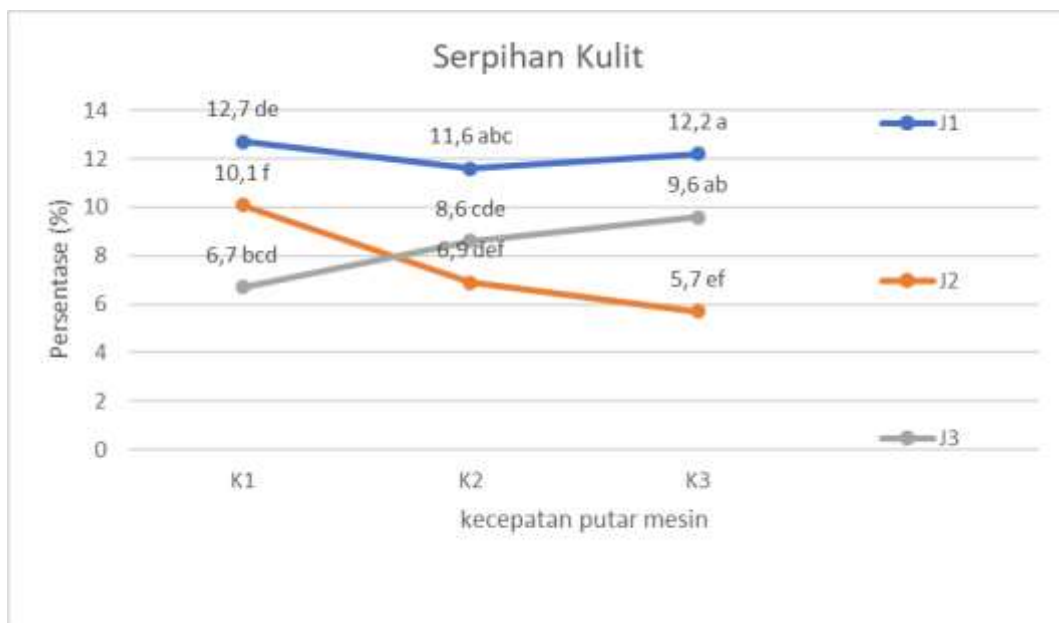
Grafik 3. Pengaruh jarak silinder pengupas dan kecepatan putaran mesin (rpm) terhadap persentase kulit terikut biji
