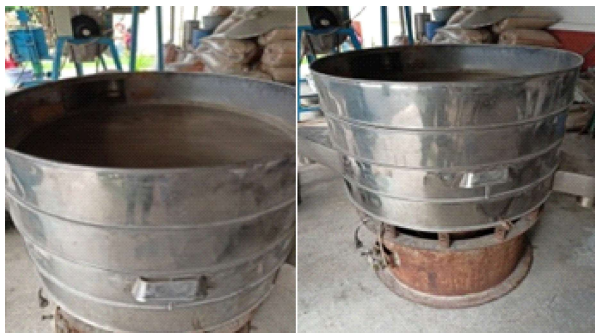
Gambar 16. Mesin pengayakan tepung porang.
