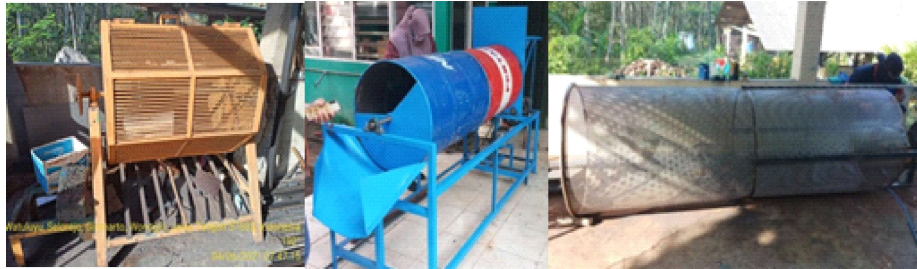
Gambar 12. Peralatan pencucian umbi porang segar.
