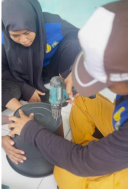
Pembuatan lubang pada wadah perangkat menggunakan bor.
