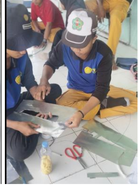
Pemotongan lembaran pelat seng sesuai pola dan ukuran yang telah ditentukan.
