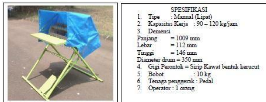
Gambar 5. Pedal thresher lipat dan spesifikasinya
