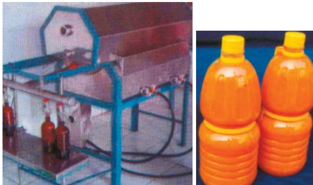
Gambar 2. Proses pemanasan bubur mangga dengan alat pasteuriser dan Puree mangga
