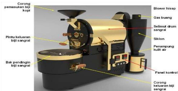
Gambar 4. Mesin Sangrai Kopi semi-automatis yang dilengkapi dengan Panel Kontrol Suhu dan Waktu
