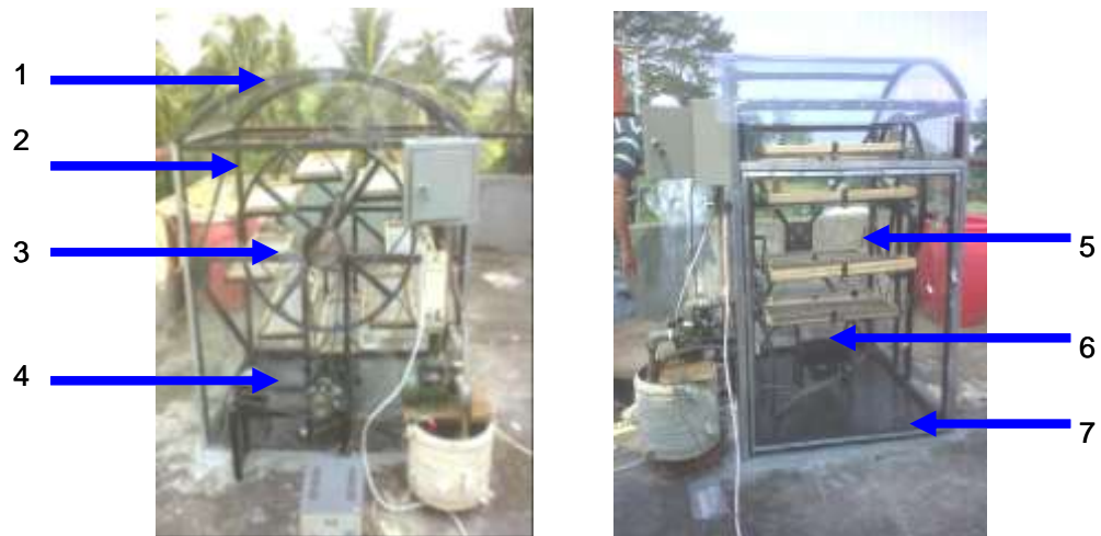
Keterangan: 1. Atap, 2. Rangka pengering, 3. Rak, 4. Radiator, 5. Lubang inlet dan outlet, 6. Kipas, 7. Lantai
