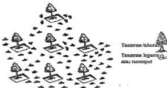
Gambar 12. Sketsa teras individu pada areal pertanaman tahunan.
