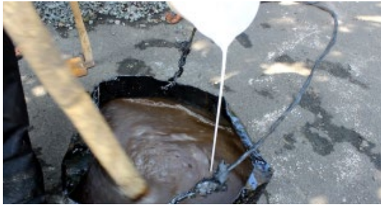
Gambar 10. Pencampuran secara manual lateks pekat depolimer dengan aspal Sumber : Puslit Karet (2016)
