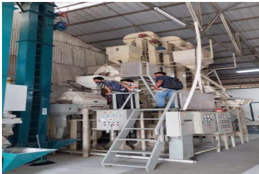
Gambar 17. Penggilingan padi untuk menghasilkan beras bermutu pada usaha penggilingan besar
