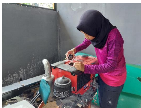
Gambar 1.5 Pengecekan Air Radiator
