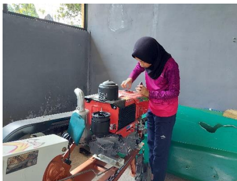
Gambar 4.5 Pengecekan Bahan Bakar pada Traktor Roda Dua
