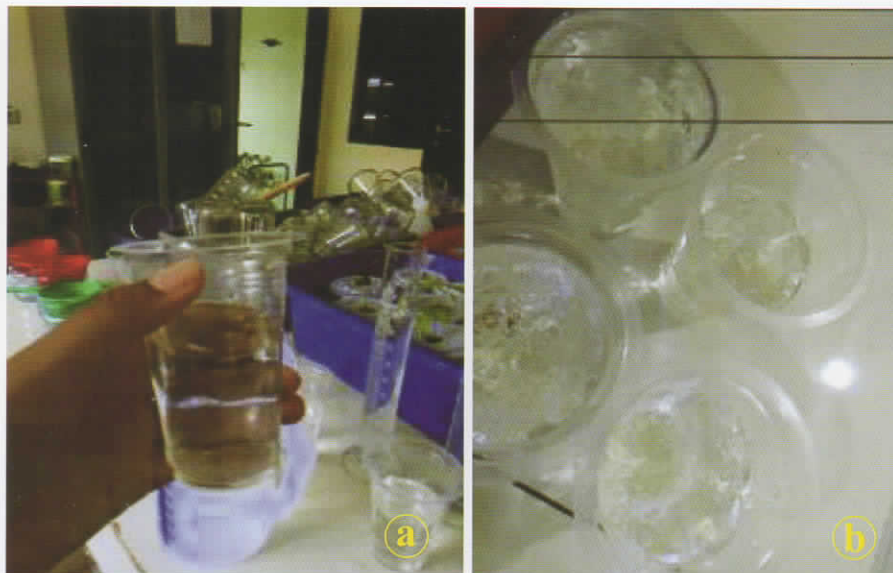
Gambar 2. (a) 0,1 gram serbuk hidrogel dilarutkan dalam 100 mL aquades; (b) hidrogel yang sudah mengembang di dalam aquades
