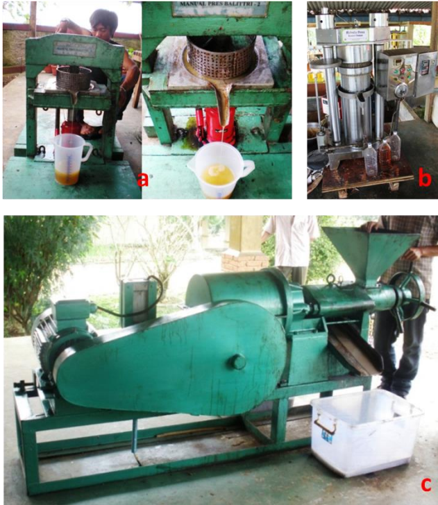
Gambar 12. Pengepresan kernel kemiri sunan menggunakan hidrolik manual (a), hidrolik elektronik (b), dan screw press (c).
