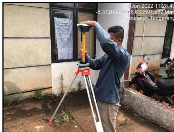
Gambar 3.3 Menyiapkan Base Station
