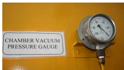
Gambar 14 Tekanan 0 setelah pembukaan saluran udara
