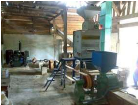
Gambar 11a. Mesin giling single –pass untuk mengupas kulit gabah menjadi bpk(Dok. http://www.google.com ) Gambar 11b. Mesin penyosoh beras pecah kulit
