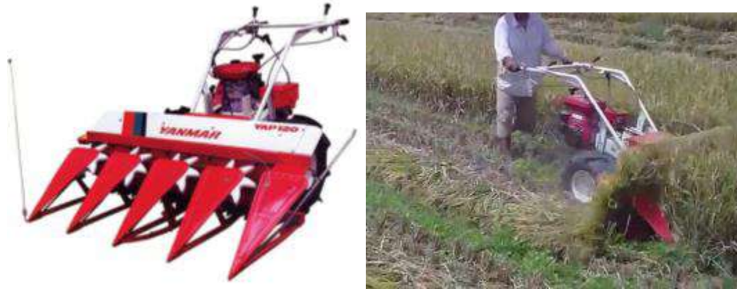
Gambar 6a. Alat panen reapper Gambar 6b. Penggunaan alat panen reapper di sawah (Dok. http://www.google.com )
