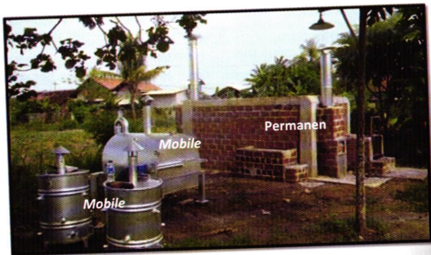
Gambar 3. Alat pembuat biochar (pirolisator) mobile dan permanen di Kebun Percobaan Taman Bogo, Lampung (Foto: Nurida)
