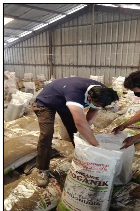
Gambar 14. Pengambilan contoh terkemas setelah dilakukan penetapan contoh primer
